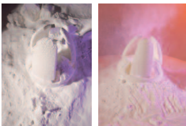
Bild 1 und 2 Produkte aus dem Pulver – Gedruckte Greifer im Lasersintern-Verfahren, Werkstoff PA12
