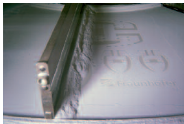
Bild 3 Technologie des Lasersinterns – Auftrag einer neuen Pulverschicht in der Produktion
