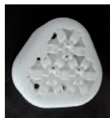
Bild 3 Leichte Dämpfungsstruktur mit integrierter Faltenbalgdämpfung
